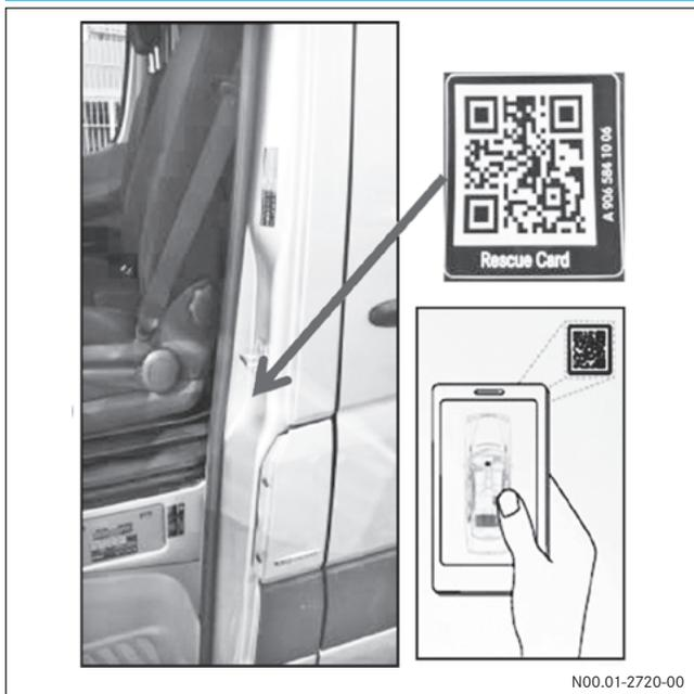
Instalação (exemplo) da etiqueta adesiva de salvamento com QR Code na coluna B esquerda (lado do motorista)
