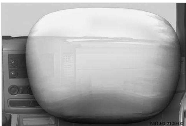
Representação esquemática da área de desdobramento do airbag do acompanhante
