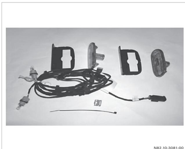
A imagem mostra um exemplo do kit de peças para um lado, para embalagem respectivamente em uma sacola para os lados esquerdo e direito do veículo, nas lanternas de posição lateral (Code LB1), sem carroceria aberta para carga seca, incl. grampos de fixação e presilhas de cabos.
