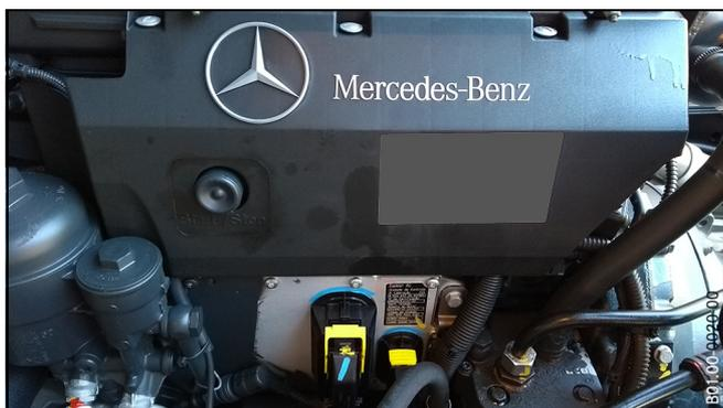
Sua conexão com todos os sensores instalados no motor é feita através de um conector de 55 vias, e com o veículo através de um conector de 16 vias.
