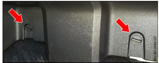
Remover os parafusos indicados na figura abaixo para ter acesso à central de conectores.
