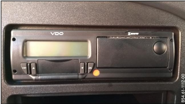
O tacógrafo possui as dimensões no padrão DIN, igual ao de um auto-rádio, onde a posição ideal de instalação está localizada no eixo longitudinal entre  $\pm 30^\circ$  do eixo horizontal.
